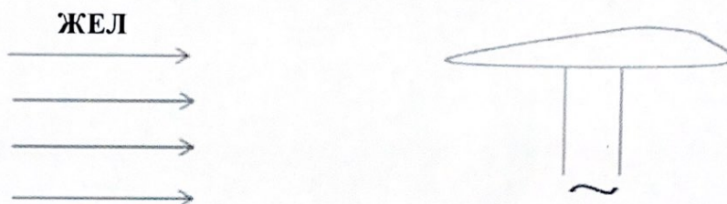
1.10-сурет - Жел әрекетінің векторы мен вентильді хорда арасындағы бұрыш 0^\circ -ға жақын
