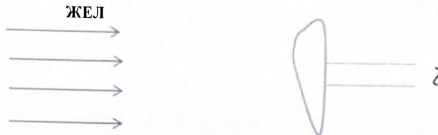
1.9-сурет - Жел әрекетінің векторы мен вентильді хорда арасындағы бұрыш 90^\circ -қа жақын
