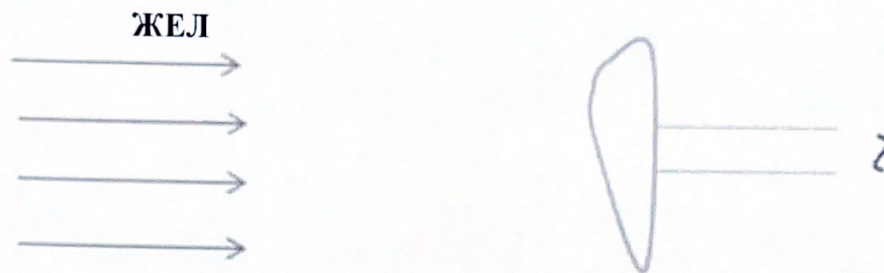
1.9-сурет - Жел әрекетінің векторы мен вентильді хорда арасындағы бұрыш 90^\circ\text{C} -қа жақын
